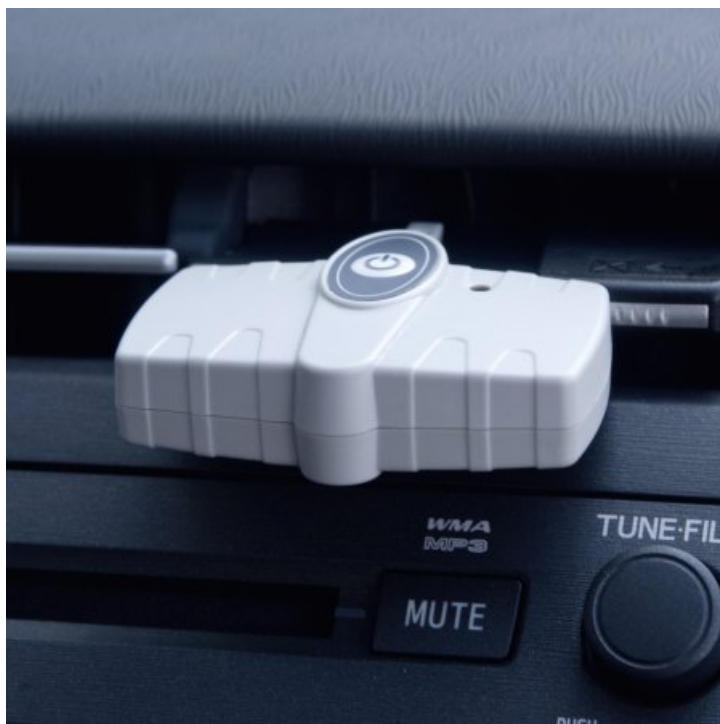
Zestaw do badania wydajności klimatyzacji-seria 700R
