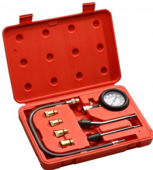
Przyrząd do badania kompresji w silnikach benzynowych
